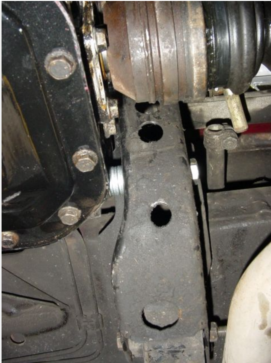
Motorsteun rechtsvoor, origineel kadett met een spacer van 40x40 mm koper met 2 bouten erin gelast(zie foto);
